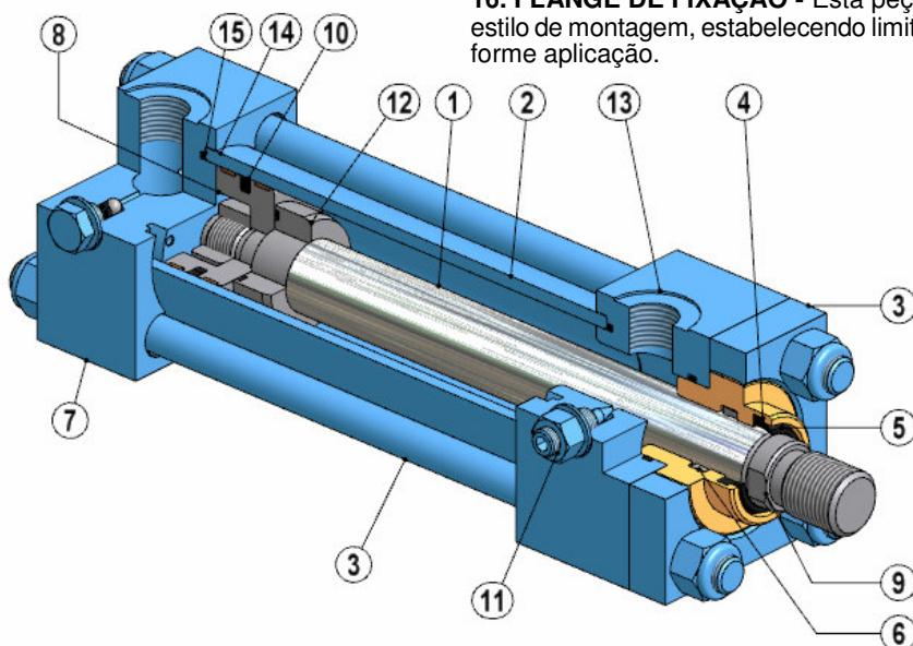
**• AMORTECEDORES HIDRÁULICOS AJUSTÁVEIS** - Os cilindros hidráulicos GL32 podem ser fornecidos com amortecedores em todos os tamanhos. Costuma-se recomendar o uso de desaceleração e parada de massas entre 10 e 20 cm/s. No entanto, os amortecedores não se prestam à desaceleração de grandes cargas com inércia considerável, nem à substituição de válvulas desaceleradoras ou de controle de velocidade. À medida que a carga de um cilindro aumenta, a velocidade limite de segurança diminui.
