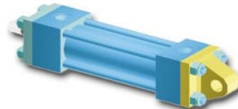
Os cilindros com montagem por aleta tipo MC e FC, são destinados para as instalações onde seja necessário movimento pivotado do cilindro, para aliviar cargas radiais excessivas. O pino foi dimensionado para resistir ao cisalhamento e não a flexão, e deve ser lubrificado periodicamente. Veja em "dimensões" os números das peças que podem ser fornecidas em separado são as mesmas.
