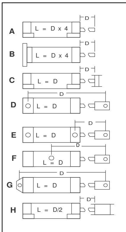
• **DIMENSIONAMENTO DA HASTE** - A tabela ao lado mostra os máximos comprimentos L admissíveis em função da carga axial aplicada na extremidade da haste e do diâmetro desta. O comprimento L é calculado da mesma maneira já descrita acima.
