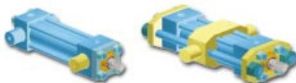
Os cilindros montados por pivôs, tipo RT, IT e HT também se destinam a cilindros que necessitem de movimento circular. Estes requerem blocos de apoio de tamanho, resistência e rigidez suficientes para apoiarem os pinos dos pivôs em toda sua extensão. Os pivôs constituem uma só peça de aço laminado, requerem lubrificações periódicas e foram dimensionados para suportar tensões de
