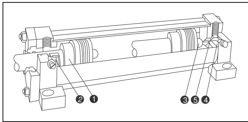
Um anel amortecedor flutuante(1) assegura o perfeito alinhamento da haste ao bloquear o fluxo de óleo. Uma válvula amortecedora(2) controla a razão de desaceleração. Há válvulas ajustáveis para cilindros de todos os tamanhos.
